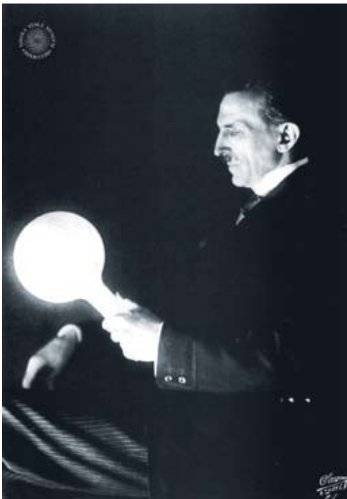
Nagyfrekvenciás Tesla-lámpa, amely vezeték nélkül világít / Wireless High-Frequency Tesla-Lamp © Tesla Museum Belgrade
